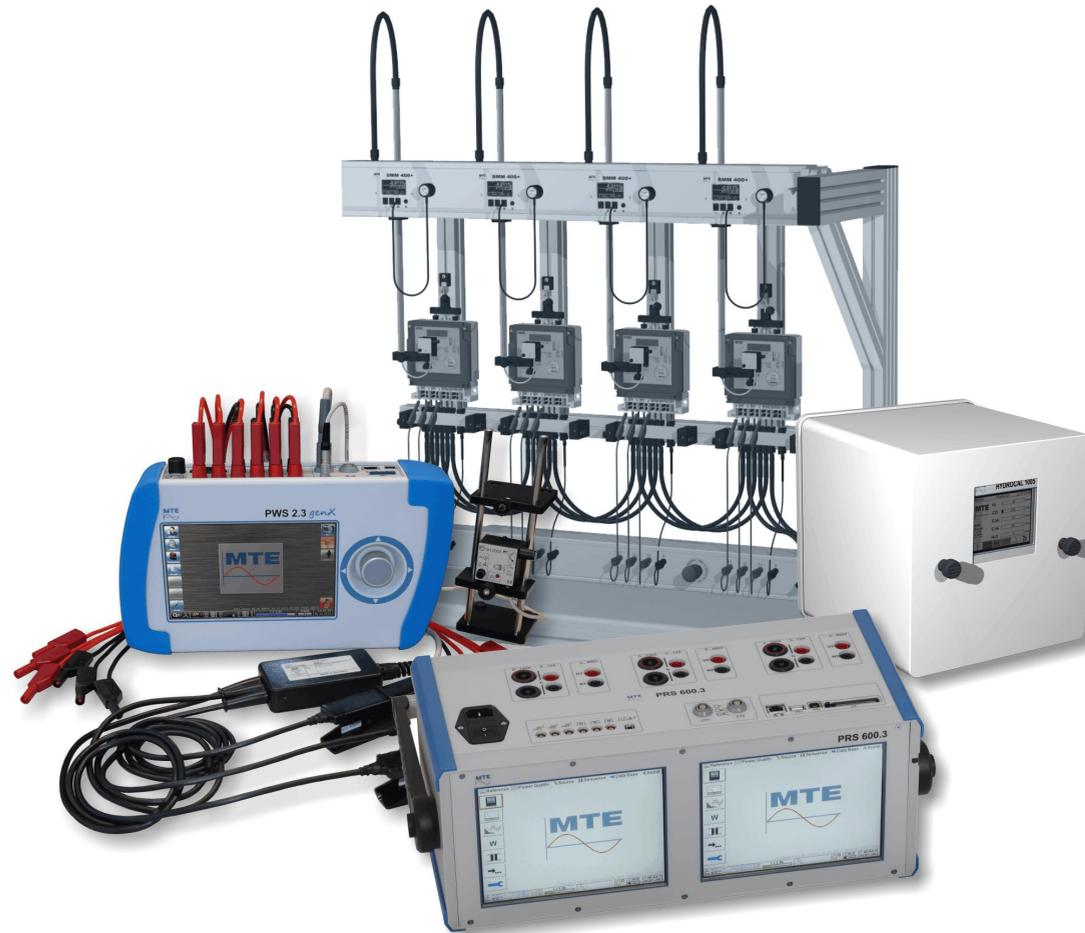
**Prüfung von Elektrizitätszählern**
