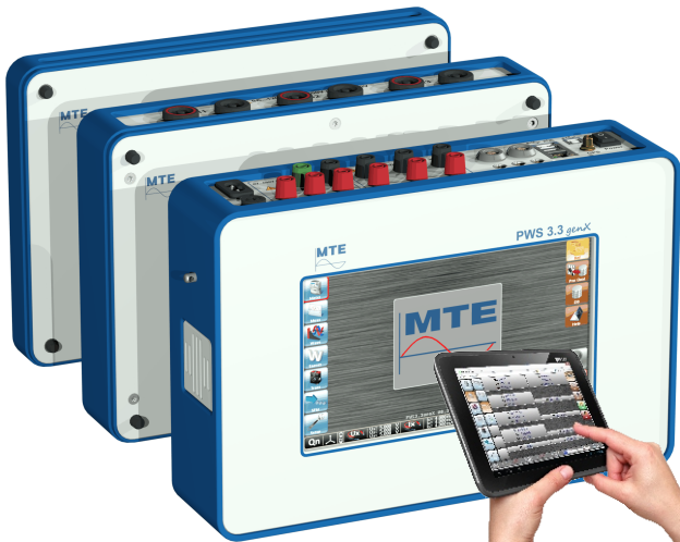
PWS 3.3 genX , Tragbares Arbeitsnormal, Genauigkeitsklasse 0.05
