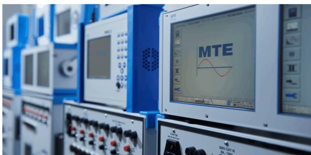
Los instrumentos de MTE monofásicos y trifásicos portátiles de ensayo, están disponibles en toda la gama completa de clases de precisión, para el uso de ensayos in situ o en laboratorios.
