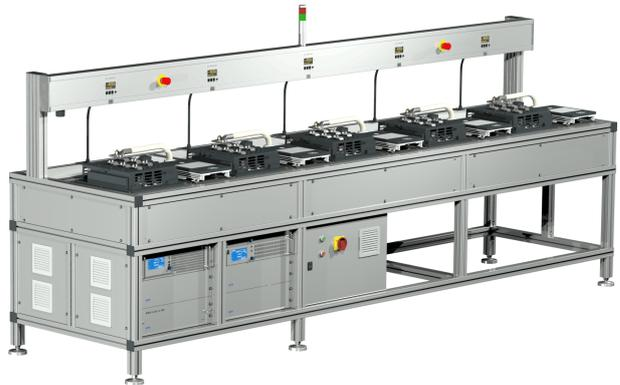
Mesa de pruebas para la calibración de 5 contadores de electricidad monofásicos DC
