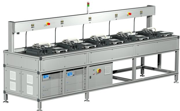
Beispiel eines Prüfsystem zur Kalibrierung von 5 einphasigen DC-Elektrizitätszähler
