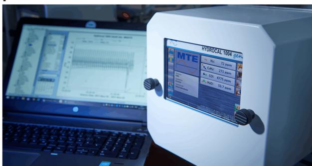
L'analyse des gaz dissous dans l'huile des transformateurs de puissance est reconnue comme l'outil le plus utile pour la détection précoce et le diagnostic des défauts naissants dans les transformateurs. Le rapport coût-efficacité de l'analyse en ligne des gaz dissous (DGA) et les systèmes de contrôle prennent de plus en plus d'importance dans le monde entier.
